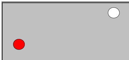
Vaixell de propulsió mecànica, d'eslora inferior a 50 m., en navegació, vist de babord
