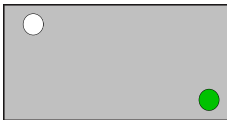
Vaixell de propulsió mecànica, d'eslora inferior a 50 m., en navegació, vist d'estribord
